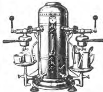
Typ 322 mit zwei Normal-Brüharmaturen mit automatischer Gas- und Wasser-Regulierung. Der Kesselinhalt wird dauernd automatisch ergänzt und automatisch auf Siedepunkt gehalten. Stundenleistung Tassen ..... ca. 125/150 oder ca. 20–25 Liter
